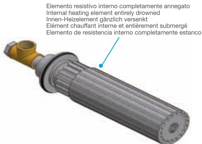
Il nome **3Flows** sta ad indicare il percorso forzato che l'acqua effettua all'interno del collettore nel quale è inserita la resistenza. Prima di uscire verso il processo l'acqua passa 3 volte a contatto dell'elemento riscaldante: si tratta pertanto di uno scambio che ottimizza la temperatura del fluido, azzerando le fluttuazioni di temperatura e fornendo una risposta immediata alle variazioni di carico termico.
